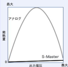
アナログアンプとデジタルアンプ (S-Master) の発熱量の変化
